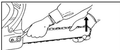
5. Tire manualmente de la cadena alrededor de la barra. Afloje el ajuste si siente que hay lugares apretados.
