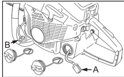
1. Retire el filtro por el orificio de aceite e inspecciónelo.
