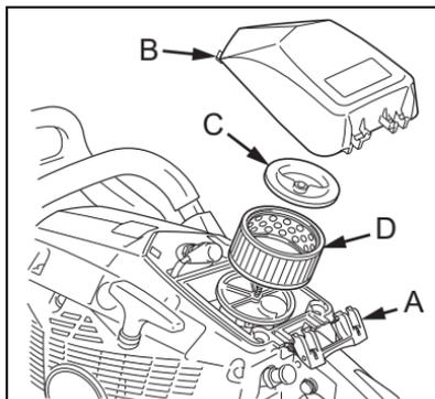
5. Cepille ligeramente el filtro de aire (D) o límpielo con aire comprimido, o reemplace el filtro de aire.
