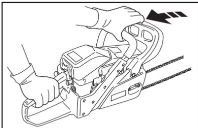
3. Sostenga la punta de la barra hacia arriba, y gire el ajustador hacia delante (+) hasta que la cadena haga contacto con la parte inferior de la barra.
