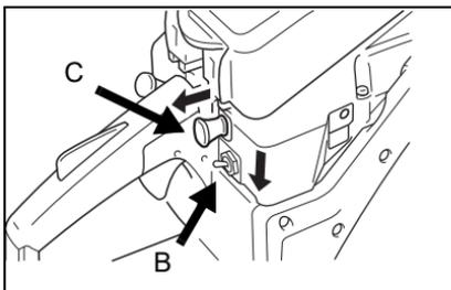
Nota: Si el motor no se detiene, tire completamente de la perilla de control del estrangulador (C) para detener el motor.
