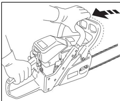
5. Confirme que la aceleración y la lubricación de la cadena y la barra sean correctas.
