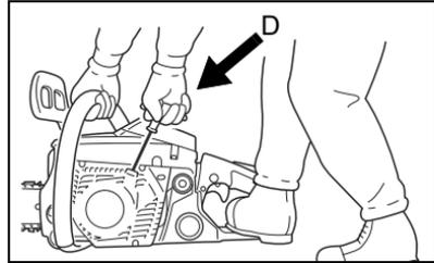
**Nota:** No tire de la cuerda del arrancador más allá de la máxima posición posible. No permita que la empuñadura de arranque retroceda y golpee la caja. Si el motor no arranca después de 5 tirones, repita las instrucciones.
