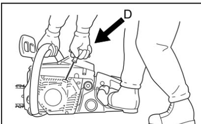
**Nota:** Si el motor no arranca después de 5 tirones, utilice el procedimiento de arranque en frío.
