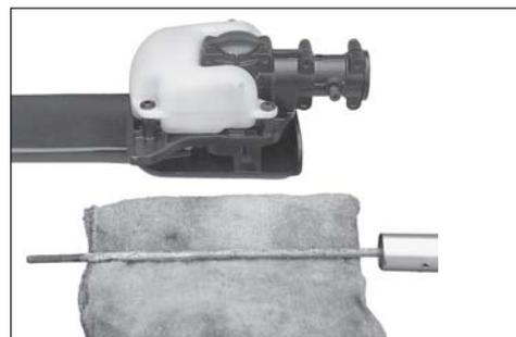
3. Emboîter l'accessoire de coupe sur le tube d'arbre de façon à ce que le trou du col de l'accessoire soit aligné sur le trou (B) du tube d'arbre. (Il peut être nécessaire de faire tourner légèrement la chaîne pour aligner le pignon de l'accessoire sur l'arbre de transmission.)
