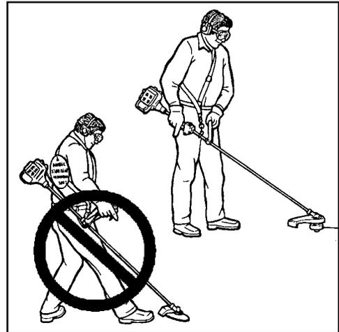
Durante la operación con la hoja, se logra la misma reducción de la fatiga. La seguridad del operador aumenta también impidiendo el contacto de la hoja con las manos y pies del operador limitando el movimiento de la recortadora.
