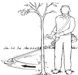
Para liberar la cuchilla atascada en el corte, detenga la unidad y sostenga el cortabordes o la desbrozadora para eliminar la tensión de la cuchilla. Empuje el árbol lejos del punto de entrada del corte para abrirlo y tire de la cuchilla directamente lejos del corte con un movimiento en línea recta. Tenga cuidado al soltar el árbol para evitar ser golpeado por su rebote o caída.
