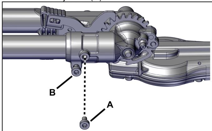
2. Cambie el ensamble del cabezal para corte.
