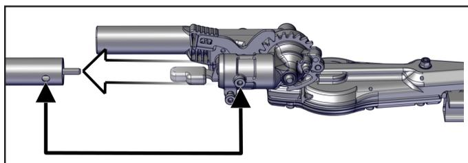
3. Instale y apriete el tornillo de ubicación (A) y apriete el tornillo de fijación (B).
