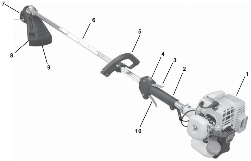
1. **CABEZAL DE IMPULSIÓN** - Incluye el motor, embrague, sistema de combustible, sistema de encendido y motor de arranque de rebobinado.
