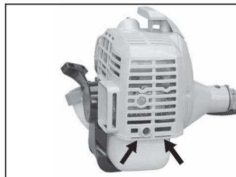
**Orificio de escape del cilindro**
