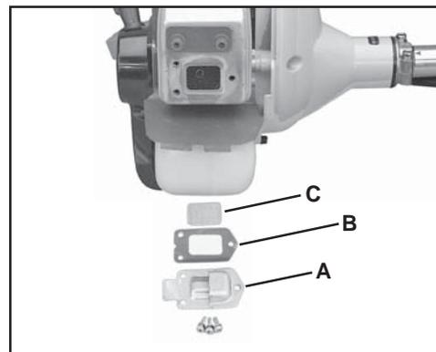
3. Limpie los depósitos de carbón de la componentes del silenciador.
