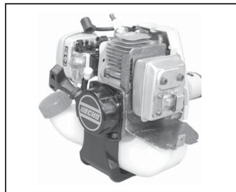
2. Quite la tapa de la rejilla del apagachispas (A), empaquetadura (B), y rejilla (C) del cuerpo del silenciador.
