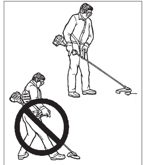
Durante la operación con cuchilla, se logra la misma reducción de la fatiga. La seguridad del operador también se mejora, al evitar el contacto de la cuchilla con las manos y pies del operador, al restringir el movimiento de la recortadora.
