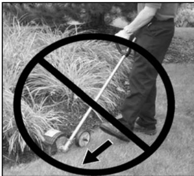
**Nota:** Tal vez sea necesario ajustar la altura de la hoja debido a diferencias de altura entre el arriate y la parte superior de la hierba.
