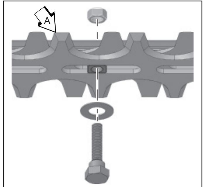
3. Ajuste la tuerca de seguridad y afloje el perno distanciador inferior de 1/2, gire a la izquierda para lograr generar un espacio entre las cuchillas. Mantenga las brechas de la cuchilla a un mínimo de 0,127 mm a 0,20 mm (0,005 pulgadas a 0,08 pulgadas) para un mejor rendimiento de corte.
