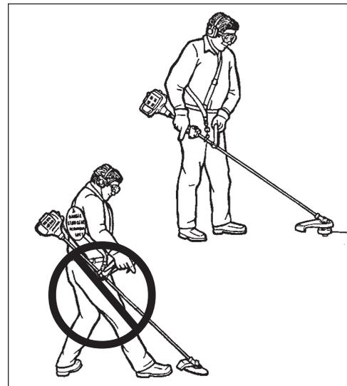
Durante la operación con cuchilla, se logra la misma reducción de la fatiga. La seguridad del operador también se mejora, al evitar el contacto de la cuchilla con las manos y pies del operador, al restringir el movimiento de la recortadora.
