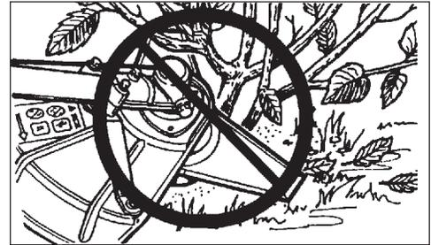
**La cuchilla de 8 dientes para maleza y hierba** (N/P 69600120331) está diseñada para hierba, desechos de jardín y maleza espesa. NO use esta cuchilla para matorrales o en plantas leñosas gruesas, de 3/4 de pulgada (19 mm) o más de diámetro. El Agarrador-U/ Conjunto de Cuchillas Transformadas N/P 99944200521 es requerido para usar con estas cuchillas.
