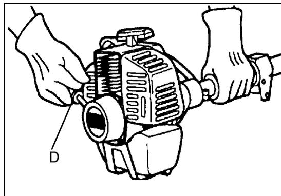
Nota: Si el motor no arranca con el estrangulador en la posición de “marcha” después de 2 a 3 tentativas, repita las instrucciones 2 - 5.
