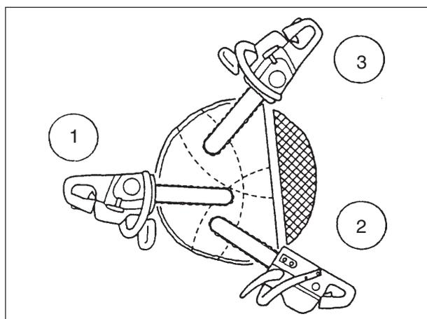
Para derribar arboles grandes, con un diámetro de más del doble de la longitud de la barra, empiece los cortes de muesca desde un lado y arrastre la sierra hasta el otro lado de la muesca.
