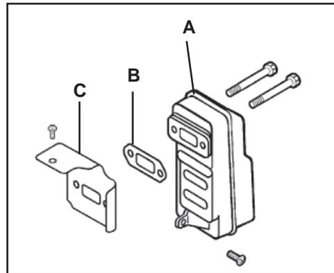
4. Inspeccione el protector térmico (C), empaquetadura (B) y reemplácela si está dañada.
