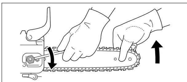
4. Monte la barra guía en los espárragos y deslícela hacia el embrague para facilitar la instalación de la cadena de sierra. Instale la cadena con los cortadores en la parte superior de la barra guía apuntando hacia adelante.
