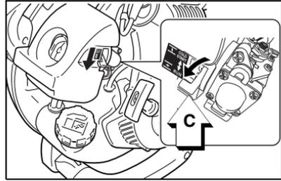
7. *Palanca de posición del acelerador*
