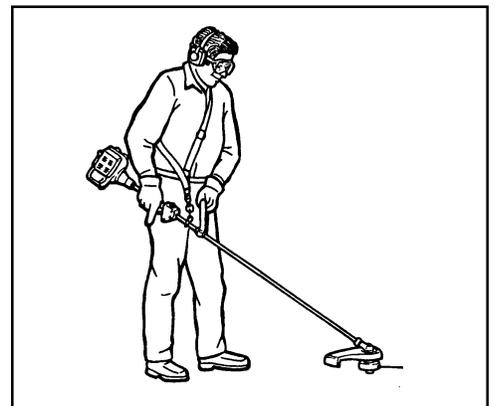
Durante la operación con la hoja, se logra la misma reducción de la fatiga. También se aumenta la seguridad del operador reduciendo la posibilidad de contacto de la hoja con las manos y pies del operador al limitar el movimiento de la recortadora.
