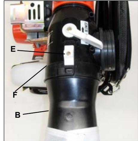
6. Coloque la tubería flexible (G) al tubo de aspiración (B) como se indica y sujételo con la abrazadera del soplador.
