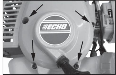
3. Quite la izquierda (A) y los derecho (B) del socket de la perno hexagonal del fondo de la cubierta del cilindro.
