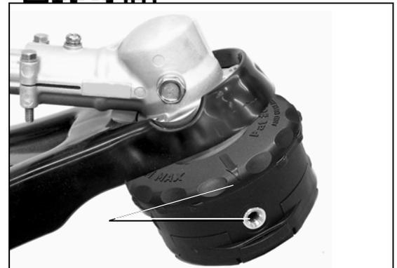
3. Inserte un extremo del hilo de la recortadora en un ojal, y empuje el hilo una misma distancia por la cabeza de la recortadora.
