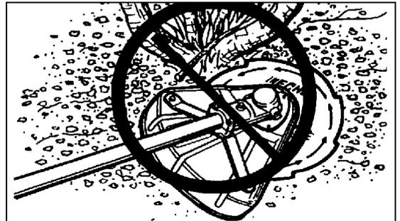
La hoja 80 dientes desbrozadora/limpiadora está diseñada para cortar broza y plantas de hasta 13 mm (1/2 pulg) de diámetro.
