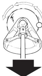
Comme le montre l'illustration, une lame tournant dans le sens contraire des aiguilles d'une montre pousse l'appareil à l'écart de l'utilisateur si le point de résistance à la coupe est du côté gauche de la lame. Si le point de résistance à la coupe est du côté droit de la lame, l'appareil est poussé vers l'arrière en direction de l'utilisateur. Dans les deux exemples, la force réactive est dans la direction opposée à la rotation de la lame au point de contact où la résistance se produit.
