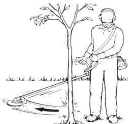
Pour dégager une lame prise dans la coupe, coupez le moteur et soutenez le coupe-herbe ou la débroussailleuse pour libérer la lame de toute tension. Poussez l'arbre à l'écart du point d'entrée de la coupe pour ouvrir celle-ci, puis tirez la lame directement hors de la coupe dans un mouvement en ligne droite. Faites preuve de prudence lorsque vous relâchez l'arbre pour éviter d'être frappé par son rebond ou sa chute.
