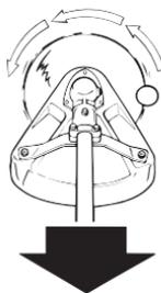
Como se muestra en la ilustración, una hoja que gira en sentido antihorario ocasionará que el equipo se aleje del operador si el punto de resistencia al corte se encuentra en el lado izquierdo de la hoja. Si el punto de resistencia al corte se encuentra en el lado derecho de la hoja, el equipo empujará hacia atrás, hacia el operador. En ambos ejemplos, la fuerza de reacción está en dirección opuesta a la rotación de la hoja en el punto de contacto donde ocurre la resistencia.
