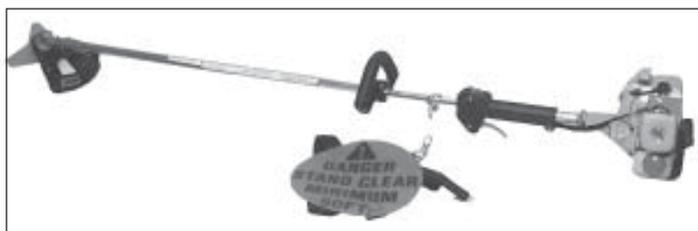
Las cuchillas de acero/metálicas requieren el «juego de conversión de cuchilla» P/N 35130454130 MAS un «juego de manubrio [C]» P/N 99944200451
