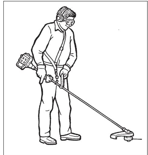
Durante la operación con cuchilla, se logra la misma reducción de la fatiga. La seguridad del operador también se mejora, al evitar el contacto de la cuchilla con las manos y pies del operador, al restringir el movimiento de la recortadora.
