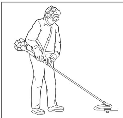
Durante un trabajo de corte con cuchilla se logra la misma disminución del cansancio. La seguridad del operador también aumenta al reducir la posibilidad de contacto de la hoja con las manos y pies del operador al restringir el movimiento de la podadora.
