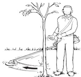
Para liberar la hoja atascada en el corte, detenga el motor, y sostenga la podadora o desmalezadora para eliminar la tensión de la hoja. Empuje el árbol para alejarlo del punto de entrada del corte para abrir el corte, y tire de la hoja directamente hacia afuera del corte en un movimiento en línea recta. Tenga precaución al liberar el árbol para evitar ser golpeado por su rebote o caída.
