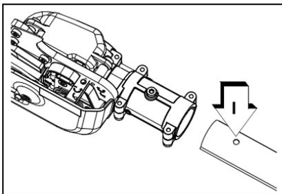
6. Instalar y apriete el tornillo de referencia (B). Apriete los dos (2) tornillos del accesorio de corte (A).
