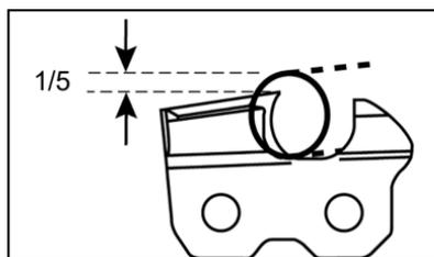
4. Lime hasta que los bordes biselados superior y laterales del cortador queden afilados sin melladuras.
