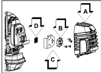
5. Limpie los depósitos de carbón de la componentes del silenciador.
