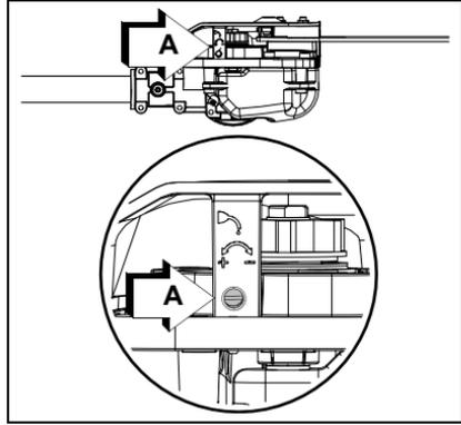
**Nota:** La aceitera automática está lista para entregar un volumen de descargas de aceite suficientes en condiciones normales de funcionamiento. Durante condiciones pesadas o secas cortantes, el volumen de la descarga de aceite puede aumentar para asegurar la lubricación adecuada. Si el aceite está escapando del área de la barra cubierta, reduzca el volumen de la descarga del aceite. Rellene el depósito de aceite con cada tanque de combustible.
