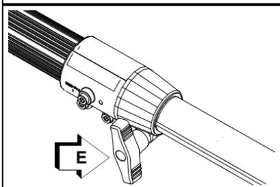
3. Tire del tubo superior del eje (F) sacándolo 127-152 mm (5-6 pulg) del tubo del eje inferior de fibra de vidrio, a continuación deslice (F) hacia adentro el tubo del eje inferior de fibra de vidrio dejando al descubierto el eje interno de la servotransmisión (G). Alinee y una el extremo del mando en forma de estrella del eje interno de la servotransmisión con el eje del accesorio de corte.
