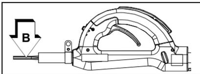
4. Alinee el acoplador del eje de impulsión flexible con el receptáculo del eje de impulsión y deslice los juntos hasta que el conjunto de empuñadura esté completamente asentado en el eje de impulsión.
