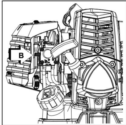
Nota: Si el motor no arranca con el estrangulador en la posición de “marcha” después de 5 tirones, repita las instrucciones 2 - 5.
