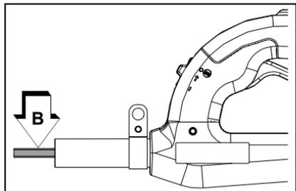
5. Saque el eje de impulsión flexible (B) 2-3 pulgadas (5 a 7.5 cm) fuera del eje de la empuñadura. NO ensucie el cable flexible.
