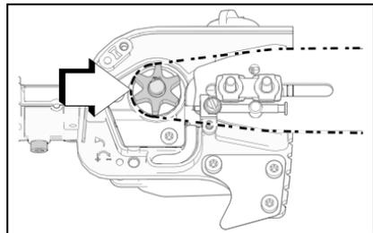
4. Instale el tapa de la rueda de impulsión (D), apriete las tuercas de la barra guía (A) con la mano, y apriete la perno de la tapa de la rueda de impulsión (B).
