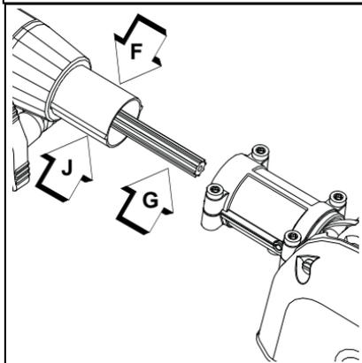
4. Alinee los bordes (J) del tubo del eje superior con las costuras del accesorio de corte.
