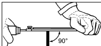
5. Ponga el calibre de profundidad firmemente encima del cortador con la ranura de 0,025 pulg y el extremo apoyado contra la rampa de seguridad delantera. Lime el rascador del cortador con la lima plana hasta que quede al ras con la parte superior del calibre de profundidad.
