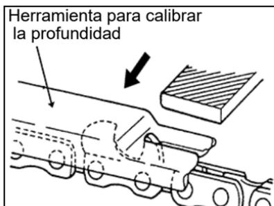
6. Termine de afilar el cortador redondeando el borde delantero del rascador con una lima plana.
