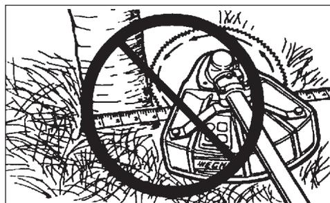
La lámina de despeje de 22 dientes (99944200130) esta diseñada para matorrales y pequeños arboles de hasta 64 milímetros (2-1/2 pulg.) en diámetro.
