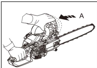
3. Apriete el bloqueo del gatillo del acelerador (G) y el gatillo del acelerador (F) gradualmente para aumentar la velocidad del motor.
