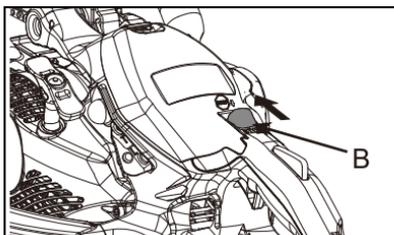
4. Sujete de manera segura la motosierra como se muestra y tire de la empuñadura de arranque (E).
