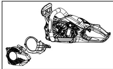
3. Use aire comprimido o una herramienta de madera para retirar la suciedad y el polvo entre las aletas con el fin de permitir que el aire de enfriamiento pase con facilidad.
