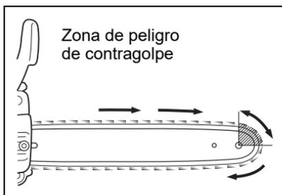
2. Agarre la sierra firmemente y manténgala así con ambas manos. Cuando el motor está funcionando, use la mano derecha sobre el mango trasero y la mano izquierda sobre el mango delantero. Agárrala firmemente, con los pulgares y los dedos rodeando los mangos de la sierra de cadena. Si agarra la sierra firmemente se ayuda a reducir el contragolpe y a mantener el control de está. No la suelte.
