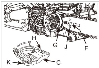
7. Alinear el conector de freno (K) en la cubierta del protector de rueda dentada (C) a la ranura en el lado de la protección delantera (A). Instale y apriete la tuerca del protector de rueda dentada (B), apretada con el dedo.
