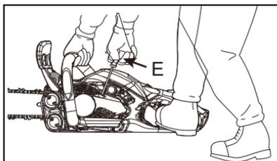
Nota: No tire de la cuerda del arrancador más allá de la máxima posición posible. No permita que la empuñadura de arranque retroceda y golpee la caja. Si el motor no arranca después de 5 tirones, repita las instrucciones.
