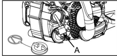
1. Retire el filtro por el orificio de gas e inspeccione el filtro.
