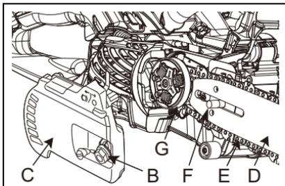
5. Monte la barra de guía (D) en el perno (F) y deslícese hacia la rueda dentada del tambor de embrague (G) para facilitar la instalación de la cadena de sierra (E). Instale la cadena de sierra alrededor de la rueda dentada del tambor de embrague y la barra de guía como se muestra, con cuchillas de cadena de sierra en la parte superior de la barra de guía hacia delante.
