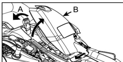
3. Desenrosque el pestillo de la cubierta del limpiador (A), levante la punta de la cubierta del limpiador de aire (B), luego deslícela hacia los lados y retírela.
