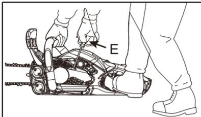
5. El estrangulador se puede utilizar si es necesario, pero después del primer sonido de arranque, apriete el bloqueo del gatillo del acelerador (G) y el gatillo del acelerador (F) para liberar el estrangulador y volver al motor a ralentí.
