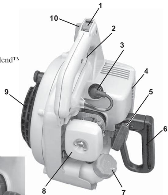
1. **INTERRUPTOR DE PARADA** - "INTERRUPTOR DESLIZANTE" montado en la parte de arriba de la empuñadura. Empuje hacia adelante para arrancar y hacer funcionar. Deslice hacia atrás para parar.
