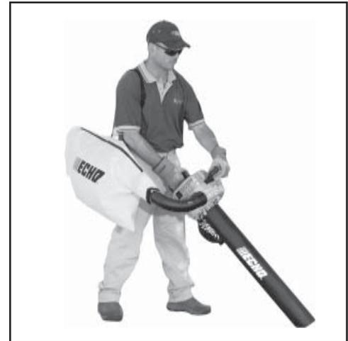
4. Vacíe la bolsa cuando el nivel de residuos alcance la abertura de admisión. Para vaciar la bolsa, ponga el interruptor de parada en la posición de "Parada" y espere a que deje de funcionar el soplador. Afloje la cinta de Velcro en el codo y quite la bolsa deslizándola por el codo. Abra el otro extremo de la bolsa y vacíe el contenido. Cierre la bolsa y vuelva a conectarla al soplador. Sujete la bolsa con la cinta de Velcro.
