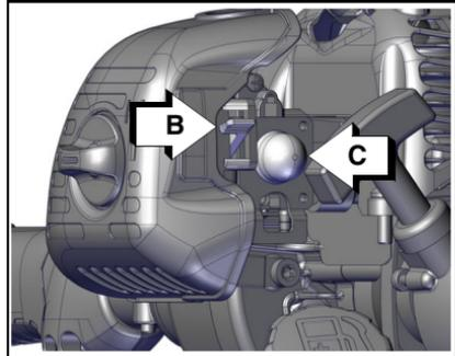
**Nota:** La energía se salva en el arrancador cada vez que se tira el handle/rope. Dos a seis tirones fáciles de los arrancador harán girar el motor. No tire al extremo de la cuerda
