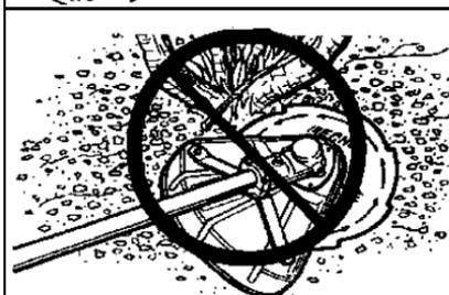
**La hoja de 80 dientes** está diseñada para cortar arbustos y crecimientos de madera de hasta to 13 mm (0,5 pulgadas) de diámetro.
