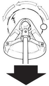
Como se muestra en la ilustración, una hoja que gira en sentido antihorario ocasionará que el equipo se aleje del operador si el punto de resistencia al corte se encuentra en el lado izquierdo de la hoja. Si el punto de resistencia al corte se encuentra en el lado derecho de la hoja, el equipo empujará hacia atrás, hacia el operador. En ambos ejemplos, la fuerza de reacción está en dirección opuesta a la rotación de la hoja en el punto de contacto donde ocurre la resistencia.
