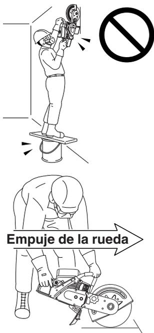
Los pavimentos de asfalto viejos, fríos y endurecidos pueden cortarse con una rueda de mampostería logrando buenos resultados y pocos problemas de alquitranado de la rueda. El asfalto fresco y las superficies alquitranadas pueden atascar la rueda y disminuir su acción de corte. Ciertos materiales impregnados de alquitrán o resina también pueden presentar problemas de esta clase.
