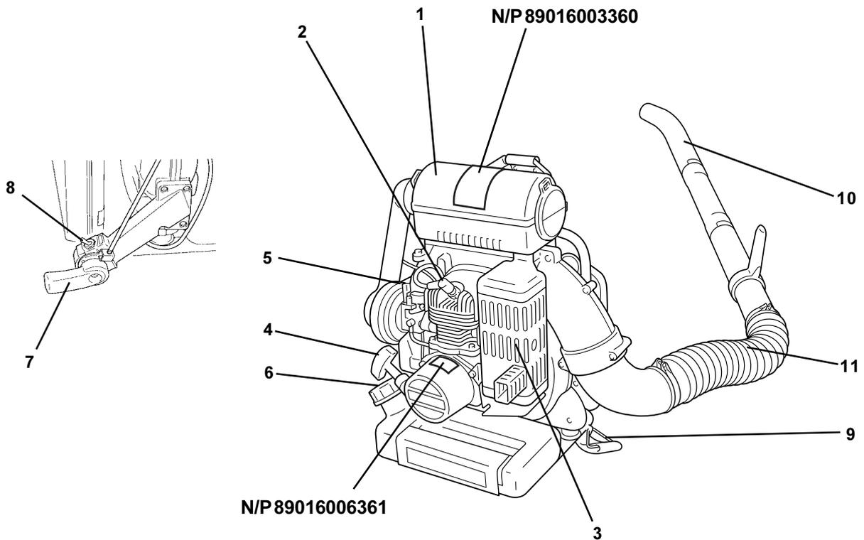
1. **LIMPIADOR DE AIRE** - Contiene el elemento de fieltro reemplazable.
