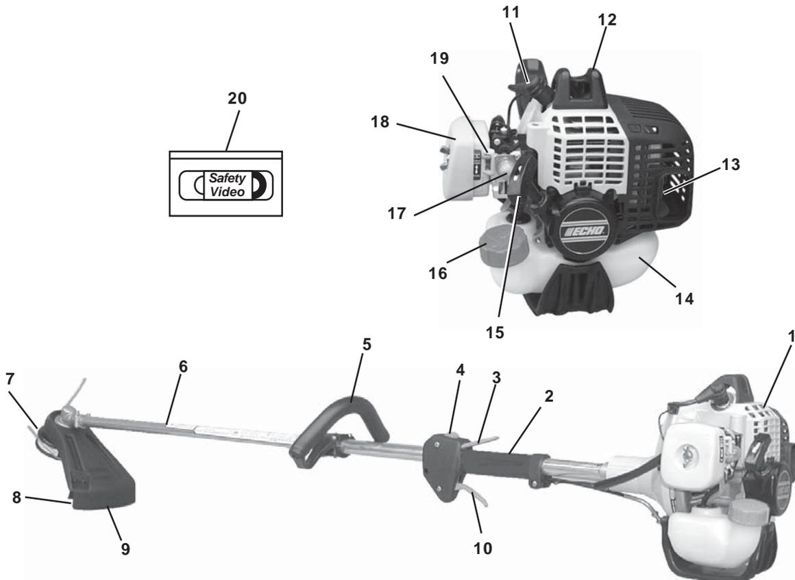
1. **CABEZAL DE IMPULSIÓN** – Incluye el motor, embrague, sistema de combustible, sistema de encendido y motor de arranque de retroceso.
