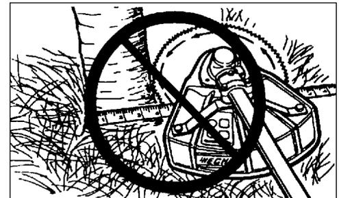
**La lámina de despeje de 22 dientes** esta diseñada para matorrales y pequenos arboles de hasta 64 mm (2-1/2 pulg.) en diámetro.
