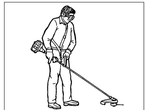
Durante la operación con la hoja, se logra la misma reducción de la fátiga. También se aumenta la seguridad del operador reduciendo la posibilidad de contacto de la hoja con las manos y pies del operador al limitar el movimiento de la recortadora.
