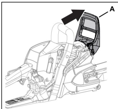
4. Empuje la bomba de purga (A) tres a cinco veces o hasta que el combustible sea visible en la bomba de purga.
