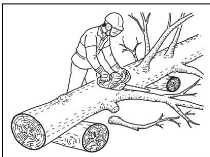
No corte con la sierra por encima de la cabeza o con la barra en una posición vertical. Se la sierra contragolpea inesperadamente, es posible que no tenga el control suficiente como para impedir posibles lesiones.
