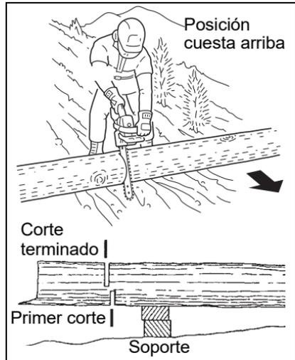
Para cortar el tronco, use el procedimiento para trozar y la secuencia de dos cortes que se muestra. El primer corte no debe ser más profundo que un tercio del diámetro del tronco.
