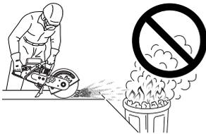
Utiliser la scie à moteur à essence dans des endroits bien aérés.
