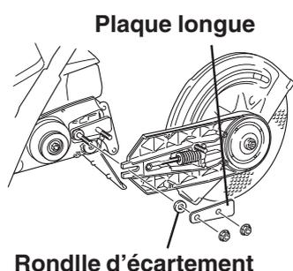
Lorsqu'il est nécessaire de couper près d'une barrière, inverser et remonter le bras de façon à ce que la meule soit du côté extérieur.
