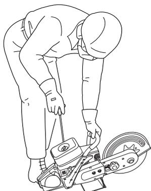
Placer la scie sur une surface plate de façon à ce que la meule ou la lame ne touche pas au sol. Tenir la poignée avant de la main gauche et retenir la poignée arrière au sol avec l'avant du pied. Il ne faut jamais faire démarrer la meule en la tenant dans les airs.
