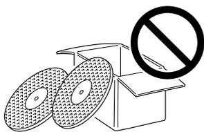
Vérifier chaque meule pour en noter les fissures, le gauchissement ou les rebords brisés avant de la monter sur la scie.
