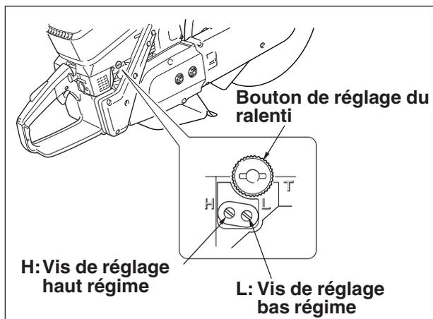
Chaque machine est testée à l'usine et son carburateur est réglé conformément aux règlements antipollution. En outre, le carburateur est équipé de limiteurs de réglage de pointeau HI et LO empêchant tout réglage hors des limites acceptables.
