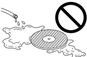
L'humidité et la chaleur peuvent causer des dommages. Il ne faut pas laisser la meule exposée au soleil ou à la chaleur intense. Conserver les meules au sec en tout temps et entreposer dans un endroit peu humide et tempéré. Il faut aussi protéger la meule de l'humidité pendant la coupe par rinçage. Pour éviter que l'eau ne pénètre la meule, faire tourner la meule à la vitesse de coupe avant d'acheminer l'eau et laisser la meule tourner pendant 10 secondes après avoir coupé l'eau.
