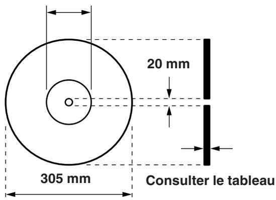
Les protecteurs fixés aux deux côtés des meules renforcées sont les coussins nécessaires pour égaliser la pression des brides de montage et éviter l'usure si du patinage survient entre la meule et les brides. Les protecteurs ont un diamètre de 108 mm. S'assurer que les protecteurs ne se creusent pas ou ne s'égratignent pas en profondeur, et qu'aucune matière étrangère ne soit présente sur la meule avant de la monter.
