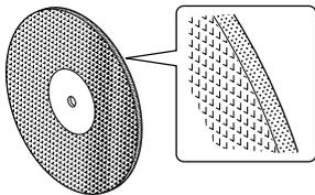
Les meules ECHO sont fabriquées en installant un treillis de fibre dans une forme, en versant un mélange de résine et de particules d'abrasifs sur le treillis et en installant un deuxième treillis par-dessus le mélange. La résine et le treillis armé sont agglomérés et durcis.
