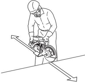
Rester à gauche de la scie de façon à ce qu'aucune partie du corps ne soit en ligne avec la meule. Garder toutes les parties du corps éloignées de la meule quand le moteur tourne.
