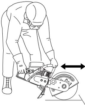
1. Comprimer et dégager la gâchette pour contrôler la commande des gaz.
