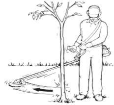
Para liberar una cuchilla que se ha atascado al realizar el corte, detenga la unidad y sujete el cortasetos o la desbrozadora para mantener la cuchilla sin tensión. Empuje el árbol lejos del punto de entrada del corte para abrir el corte y tire de la cuchilla directamente para sacarla del corte con un movimiento en línea recta. Tenga cuidado al liberar el árbol para evitar ser golpeado por un rebote o una caída.
